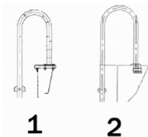
Imagen 1 muestra cómo instalar en la piscina de madera. De acuerdo con el tamaño de la instalación, use los tornillos para fijar el pie de acero inoxidable y luego enganche la escalera al pie.
